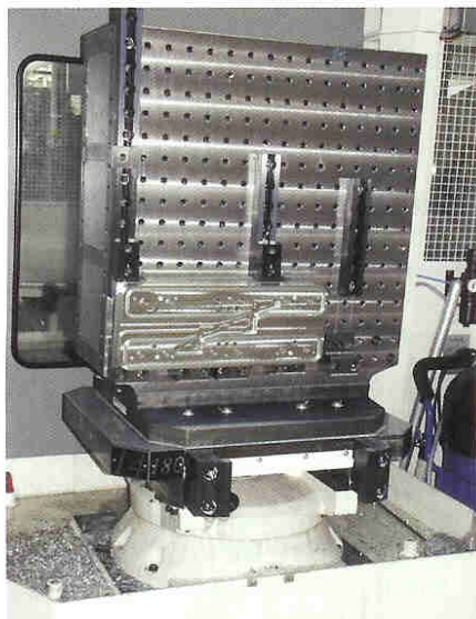
Formatwerkzeug aus Aluminium: Auf jeder Palette wird ein Spannwürfel oder ein Doppelwinkel positioniert. Bis zu 20 verschiedene Fertigungsteile lassen sich darauf aufspannen.
