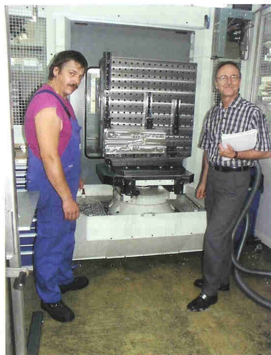
Fertigungsleiter Heinz Brodkorb (rechts): »Ohne die Spannsysteme von Halder wären wir nicht in der Lage, die Aluminiumklötze exakt in der Maschine zu positionieren.«
