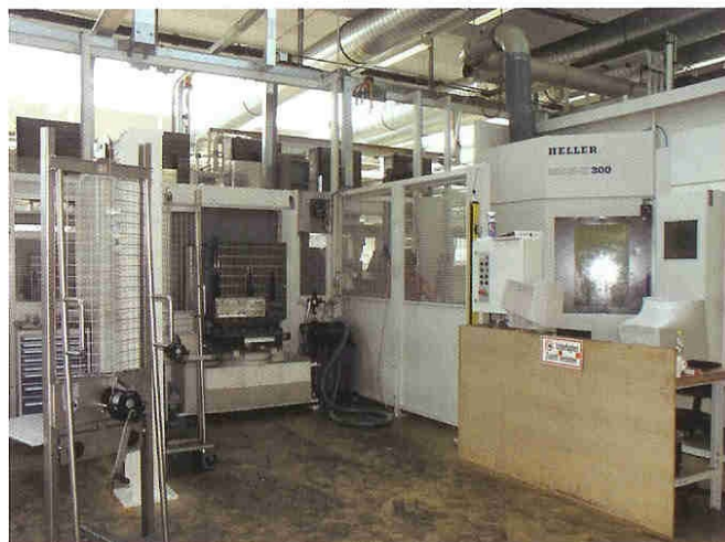
Wirtschaftlich: Das FMS ermöglicht zusammen mit den Heller-Fräszentren einen Rund-um-die-Uhr-Betrieb bei nur achtstündiger Anwesenheit des Personals.
